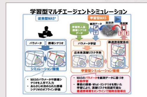
図3 学習型マルチエージェントシミュレーション 従来のマルチエージェントシミュレーションとは異なり、学習型マルチエージェントシミュレーションでは、シミュレーターのパラメーターを、取得したデータを基に学習することで、リアルタイム性と先行性を実現している。
