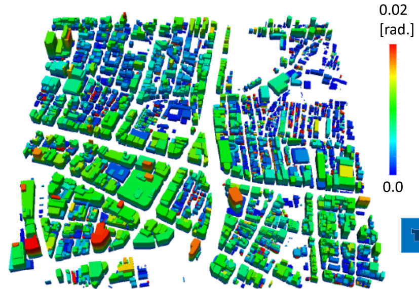
建造物の応答 (層間変形角)
